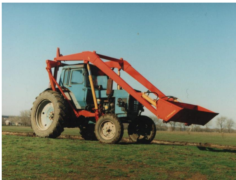
Рис.1а Стогометатель-погрузчик с ковшом в агрегате с трактором МТЗ
