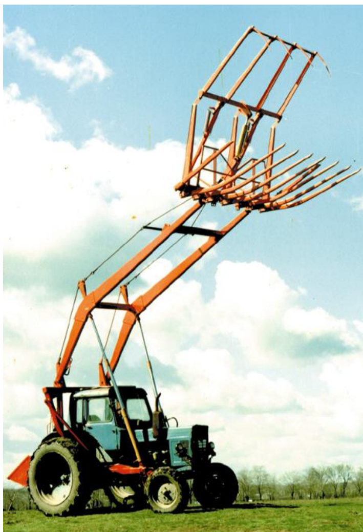
Рис.1б Стогометатель-погрузчик с платформой в агрегате с трактором МТЗ
