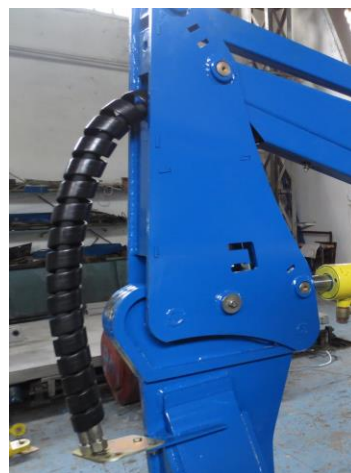
Рис.17 Пластиковая спиральная защита для РВД
